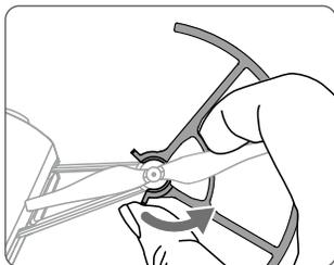
⚠ 拆卸桨叶保护罩时请格外小心，请勿使用暴力。否则可能损坏机臂或割伤手指。
