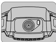
状态指示灯指示当前飞控系统的状态。请参考下表了解不同的闪灯方式所表示的飞控系统状态。
