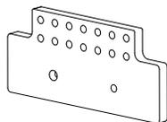
DIY 转接：14 pin 扩展口转 2×7 pin 2.54 mm 间距直插封装、5 V/3.3 V 电源指示灯预留位置 ×2、调试用指示灯预留位置 ×2，方便用户新增传感器及调试，实现更多创意功能。
