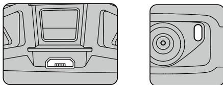
充电过程中状态指示灯蓝灯慢闪, 当变成蓝灯常亮表示充电完成, 请断开充电器连接。
